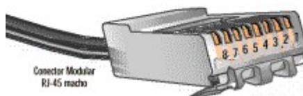
Pinagem/polarização dos conectores RJ-45
