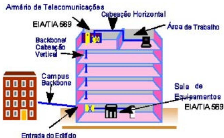
Fig : 1-Entrada de serviço; 2-Sala de equipamentos; 3-Cabeamento backbone; 4-Armário de telecomunicações; 5-Cabeamento Horizontal;6-Área de Trabalho.
